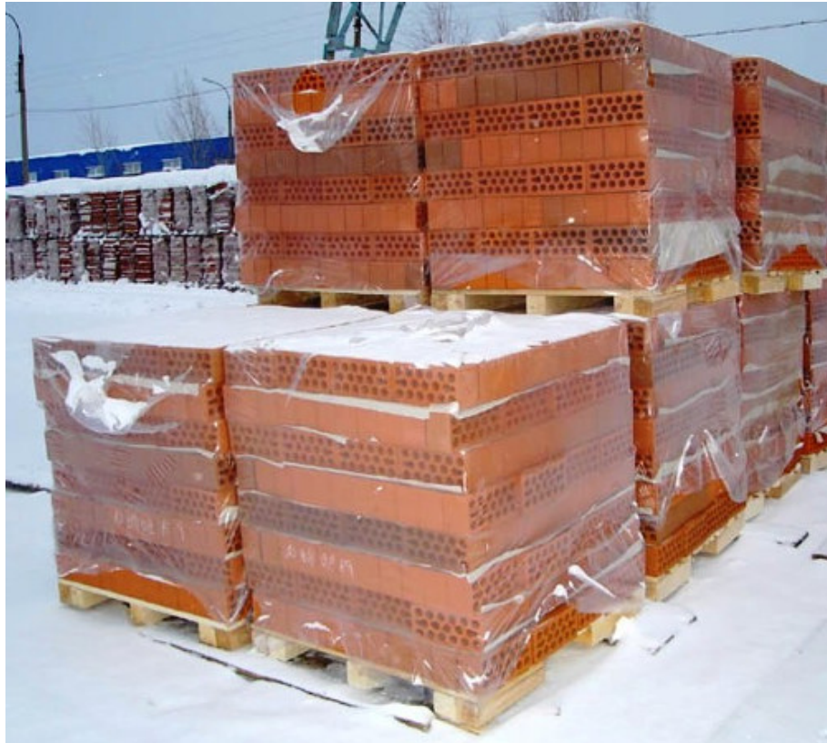
Obr. 14: Zafóliované palety s děrovanými cihlami, zdroj: [27]
