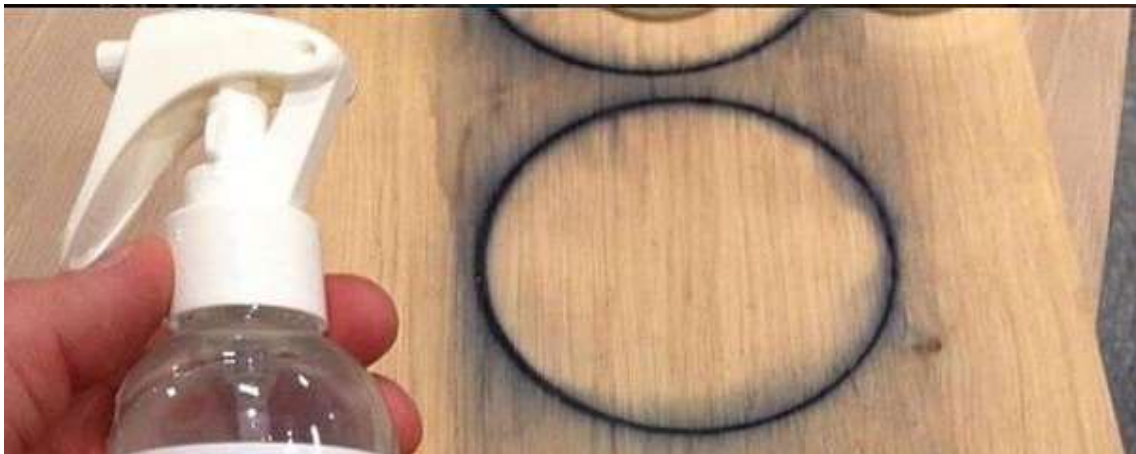
Obrázek 52 Zbarvení dřevěného povrchu po kontaktu se zeminou a kovem
