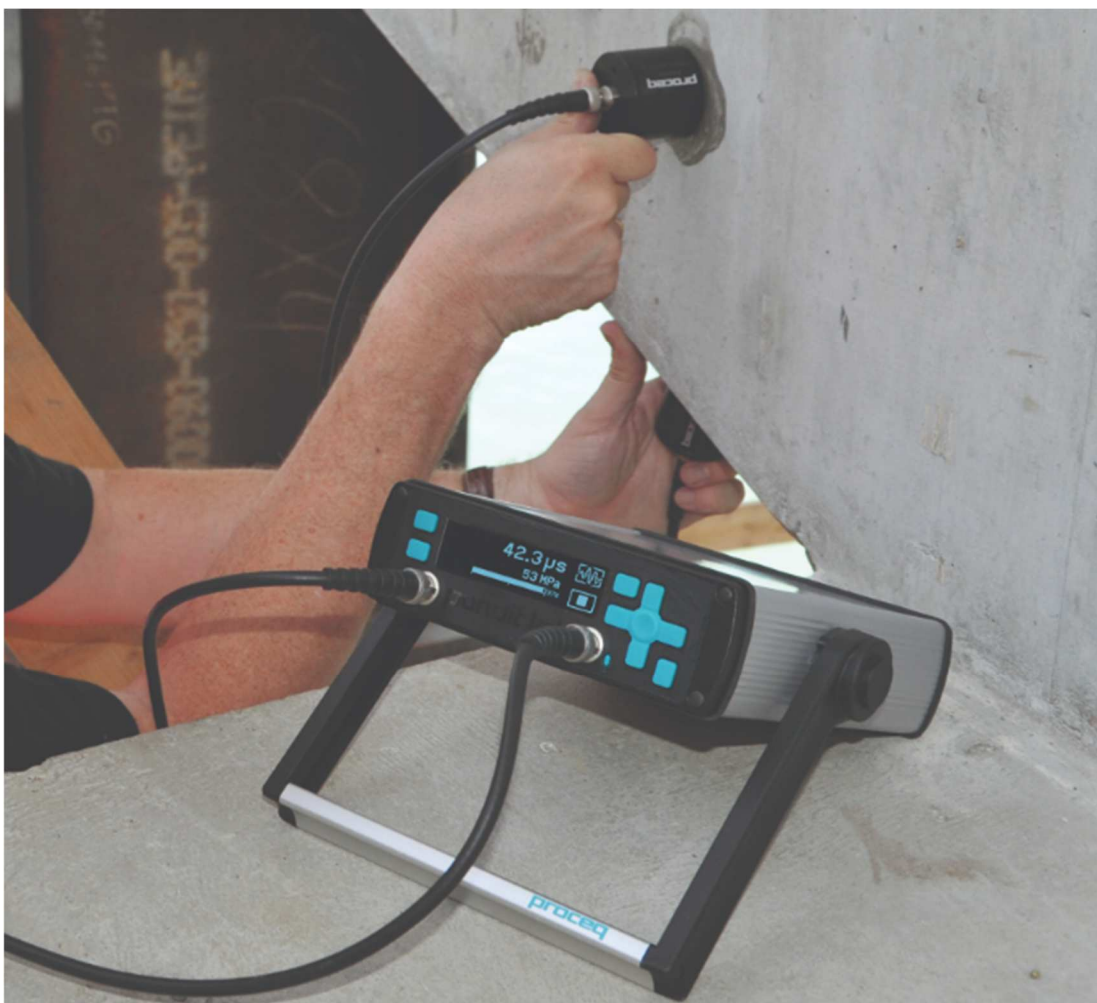
Obrázek 15: Zařízení pro stanovení doby průchodu impulsu s číslicovým ukazatelem [20]
