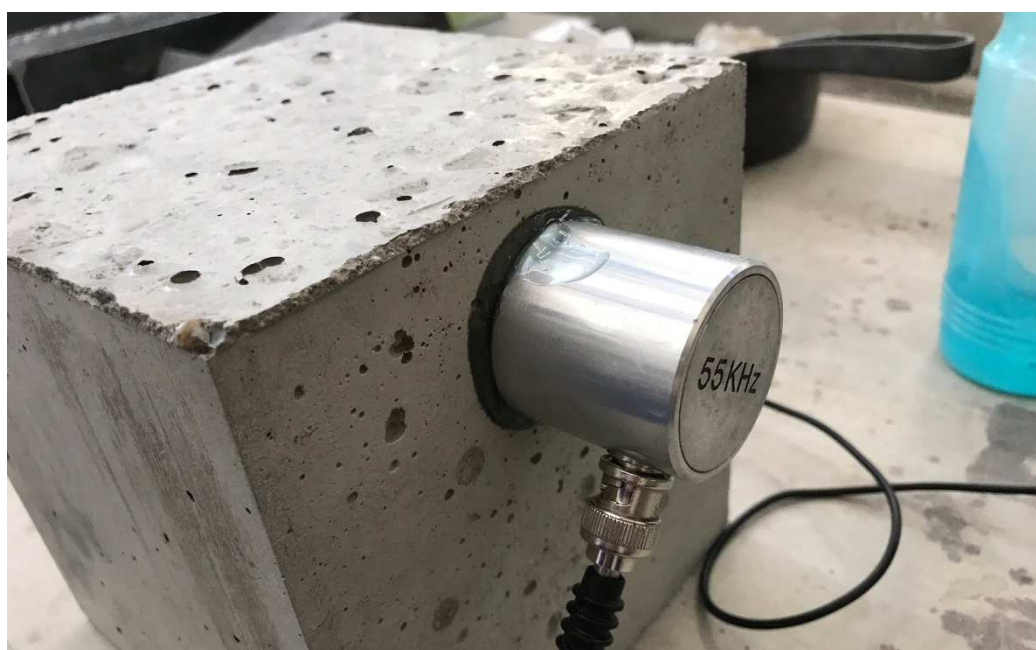
Obrázek 28: Osazení sondy na povrch betonu
