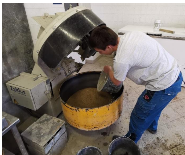
Obr. 5.14: Sypání navážených materiálů do míchačky
