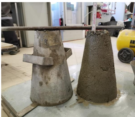
Obr. 5.15: Zkouška sednutím kužele – měření sednutí – S1 (10 mm)
