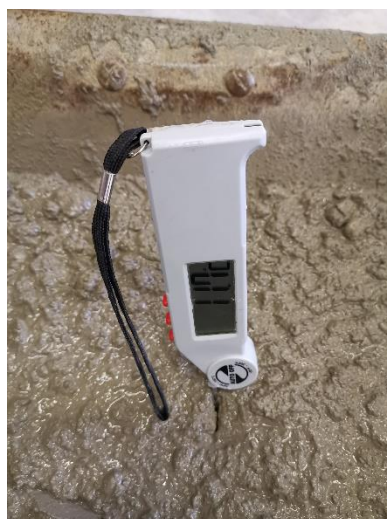
Obr. 5.7: Měření teploty betonu
