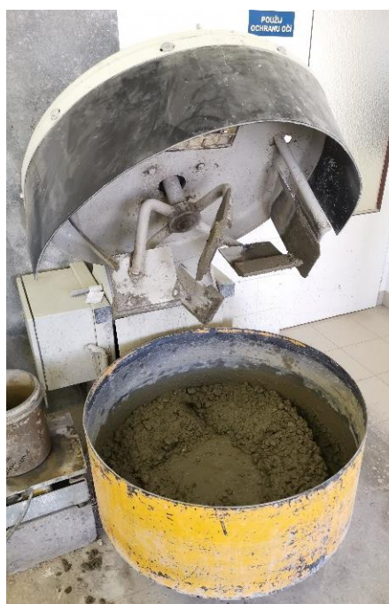
Obr. 5.16: Míchání betonové směsi v míchačce
