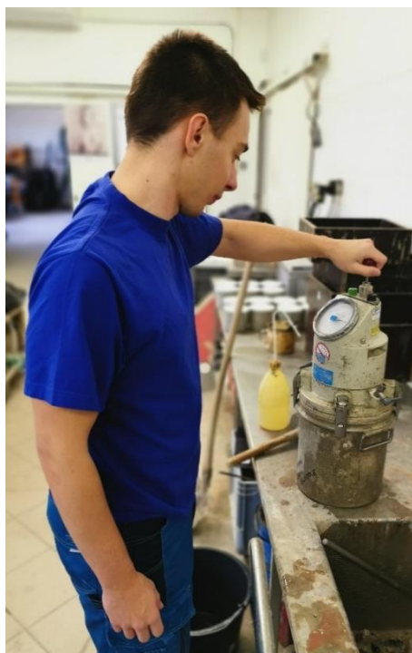
Obr. 5.8: Měření obsahu vzduchu
