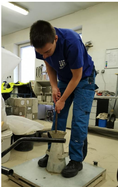
Obr. 5.9: Zkouška sednutí kužele
