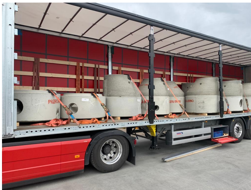
Obrázek 8- Upevnění nákladu betonových skruží
