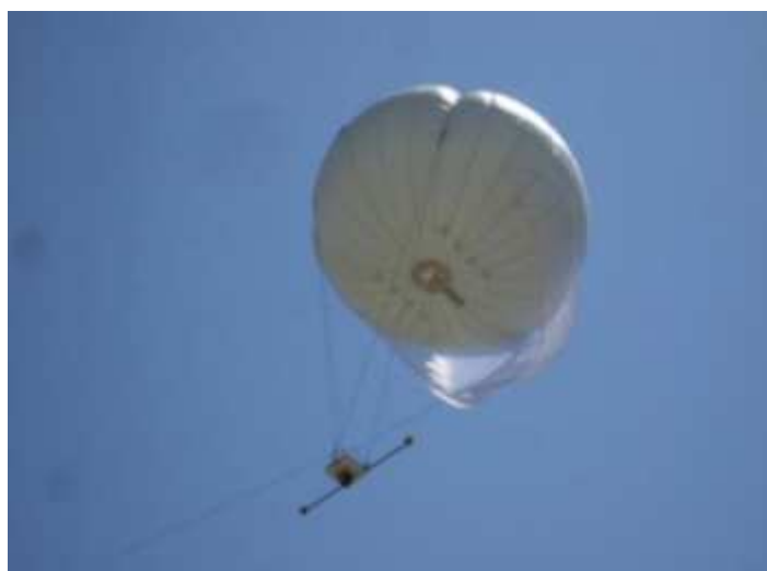
Obrázek 2.3: Héliový balón jako nosič MLS; zdroj: [13]
