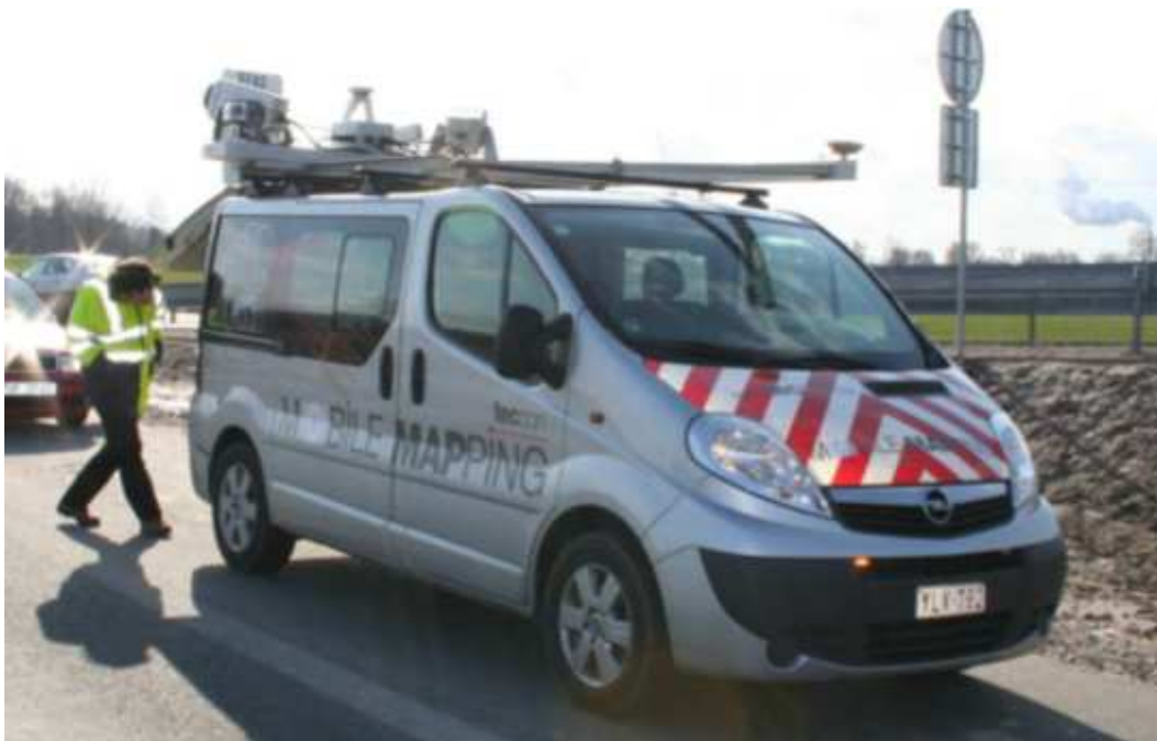
Obrázek 2.1: Automobil jako nosič MLS; zdroj: [12]
