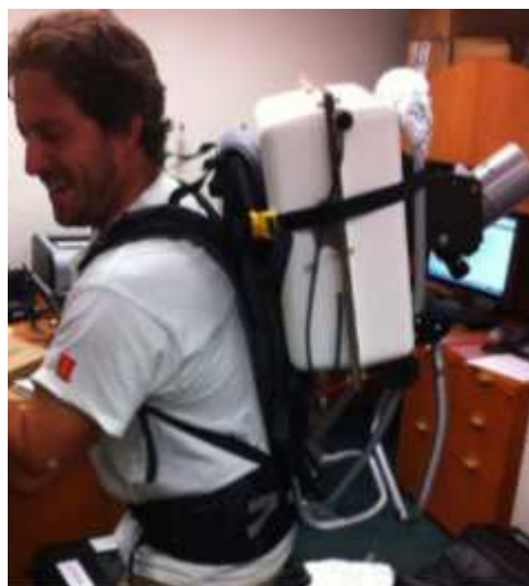
Obrázek 2.2: Batoh s MLS aparaturou; zdroj: [13]
