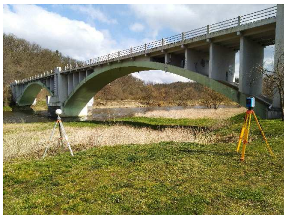
Obr. 7.1 Z+F 5016 IMAGER a referenční koule při skenování z druhé pozice
