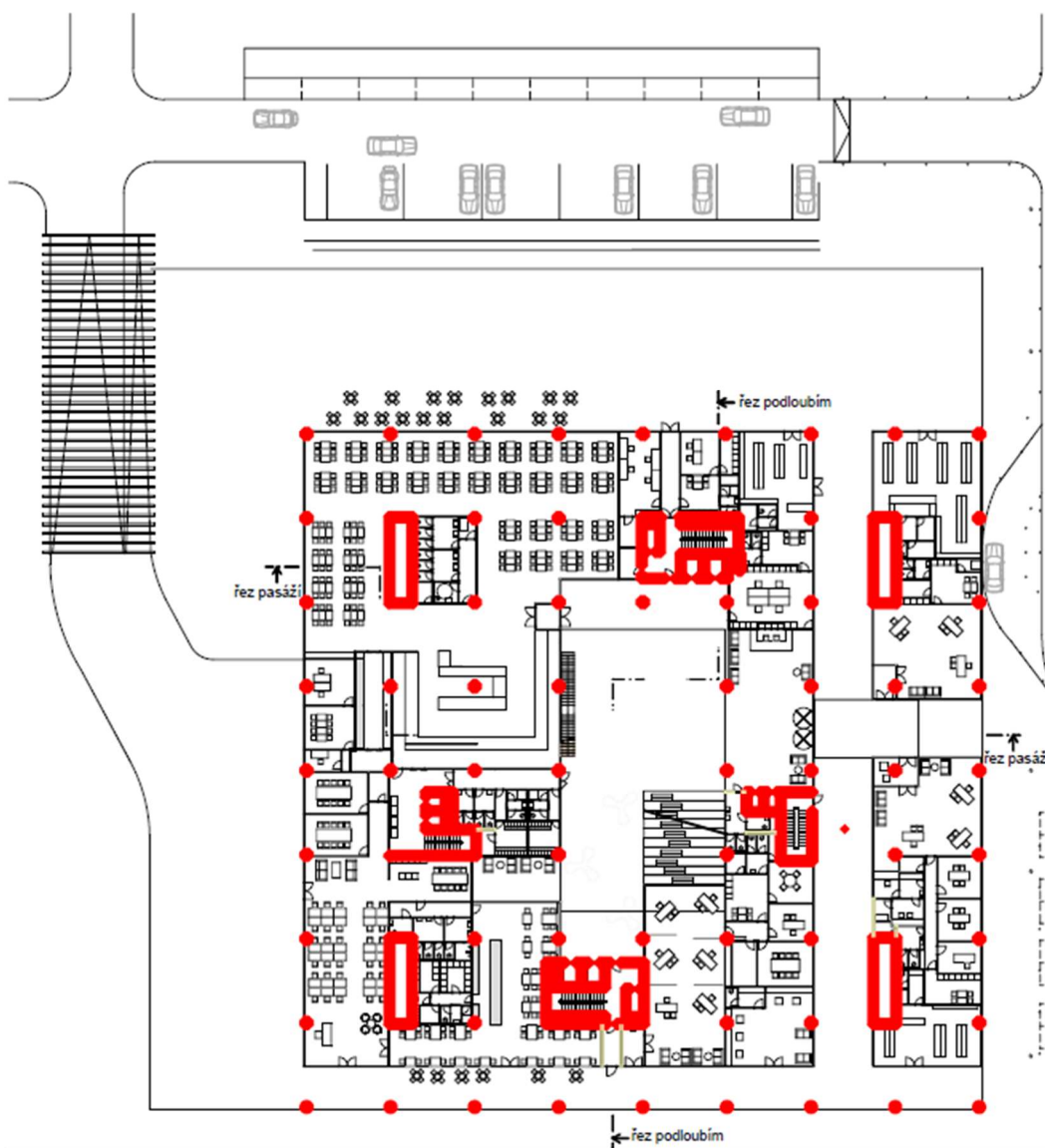
Obrázek 5- Svislé nosné konstrukce 1.NP
