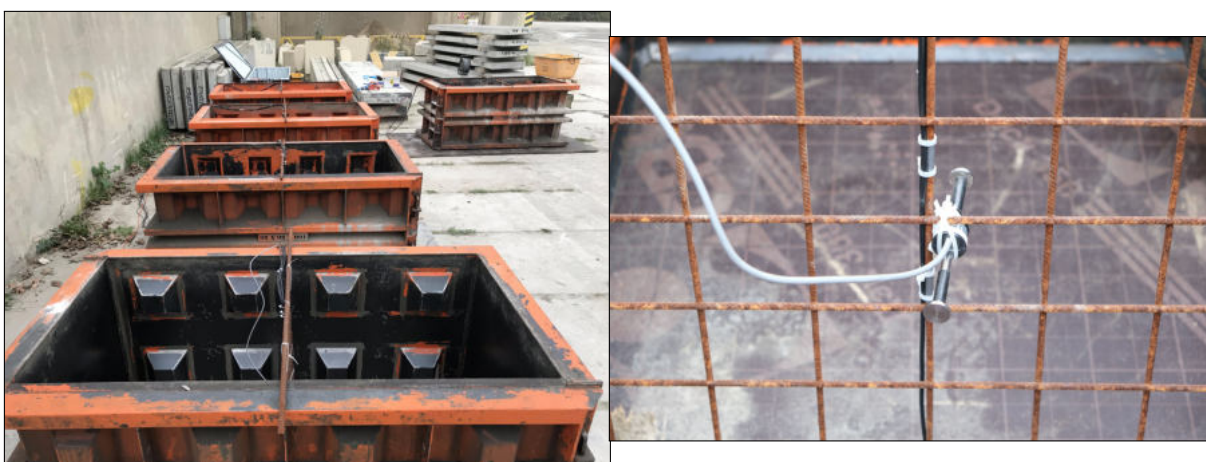
Obrázek C.2: Formy na betonáž masivních bloků k měření vývinu hydratačního tepla; Detail uchycení tenzometru a teplotních čidel.
