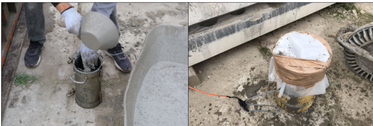
Obrázek C.13: Plnění forem s umístěným tenzometrem pro měření smrštění; Válec s tenzometrem izolovaný polyethylenovou fólií proti pronikání vody.
