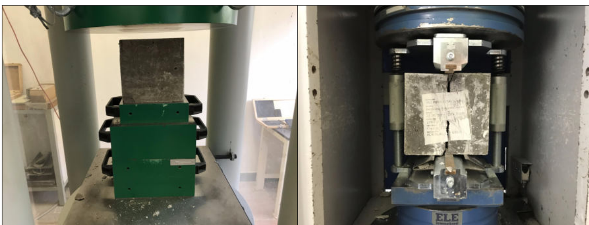
Obrázek C.16: Těleso po porušení při zkoušce pevnosti betonu v tlaku; Těleso po porušení po zkoušce pevnosti betonu v příčném tahu.
