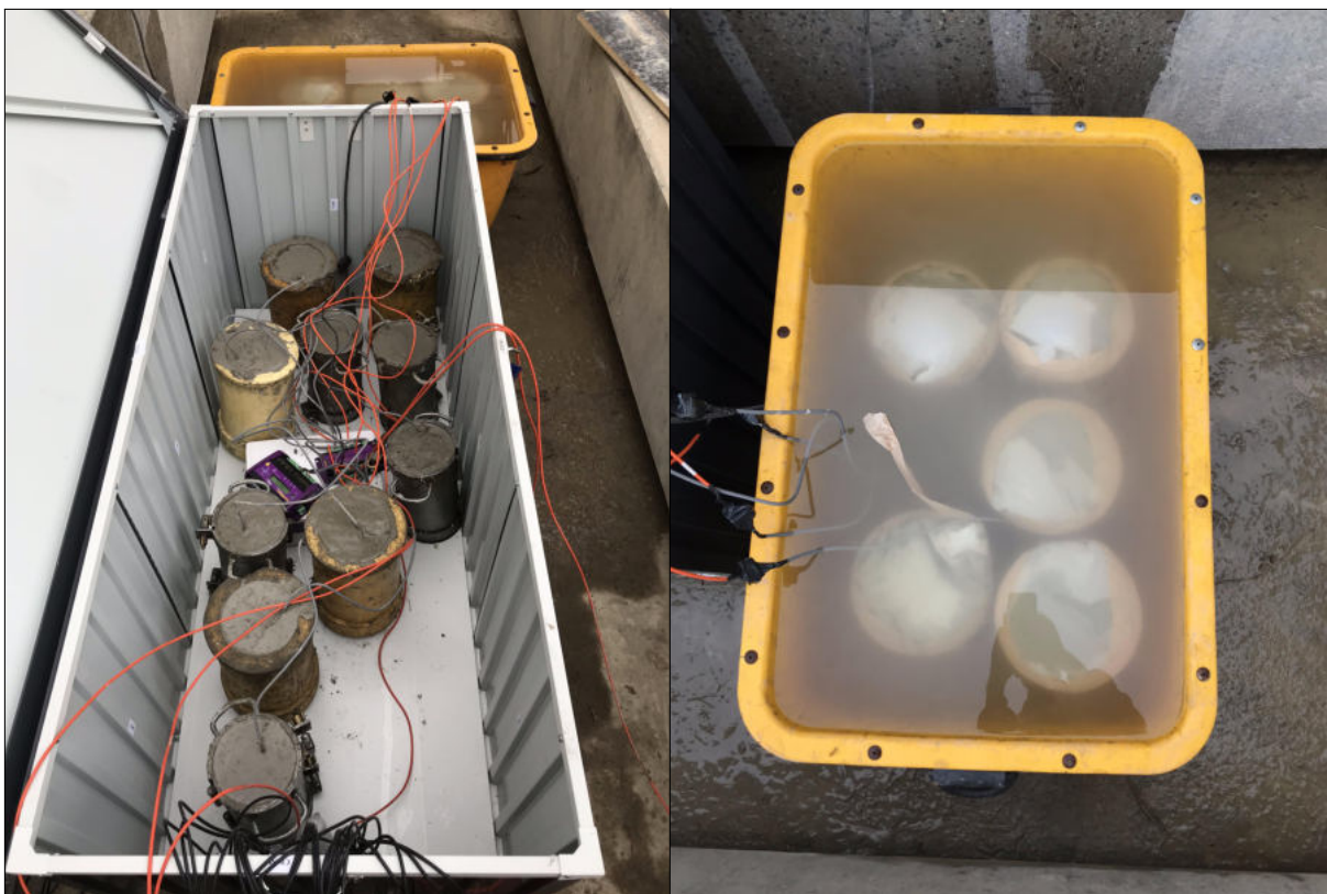
Obrázek C.14: Uložení válců s tenzometry v uzavřené plechové bedně; Uložení válců s tenzometry ve vodní lázni.
