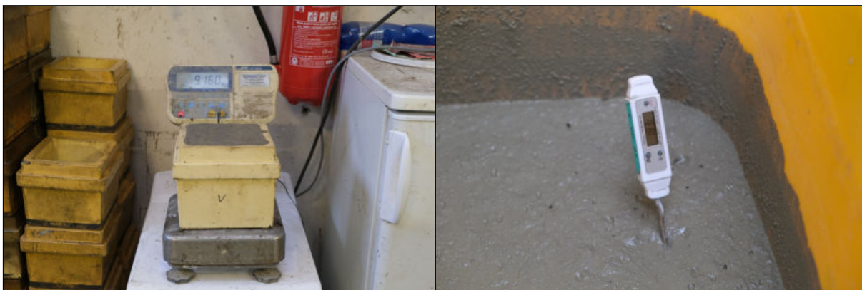
Obrázek C.8: Vážení hmotnosti betonu o známém objemu ke stanovení objemové hmotnosti čerstvého betonu; Měření teploty čerstvého betonu vpichovým teploměrem.
