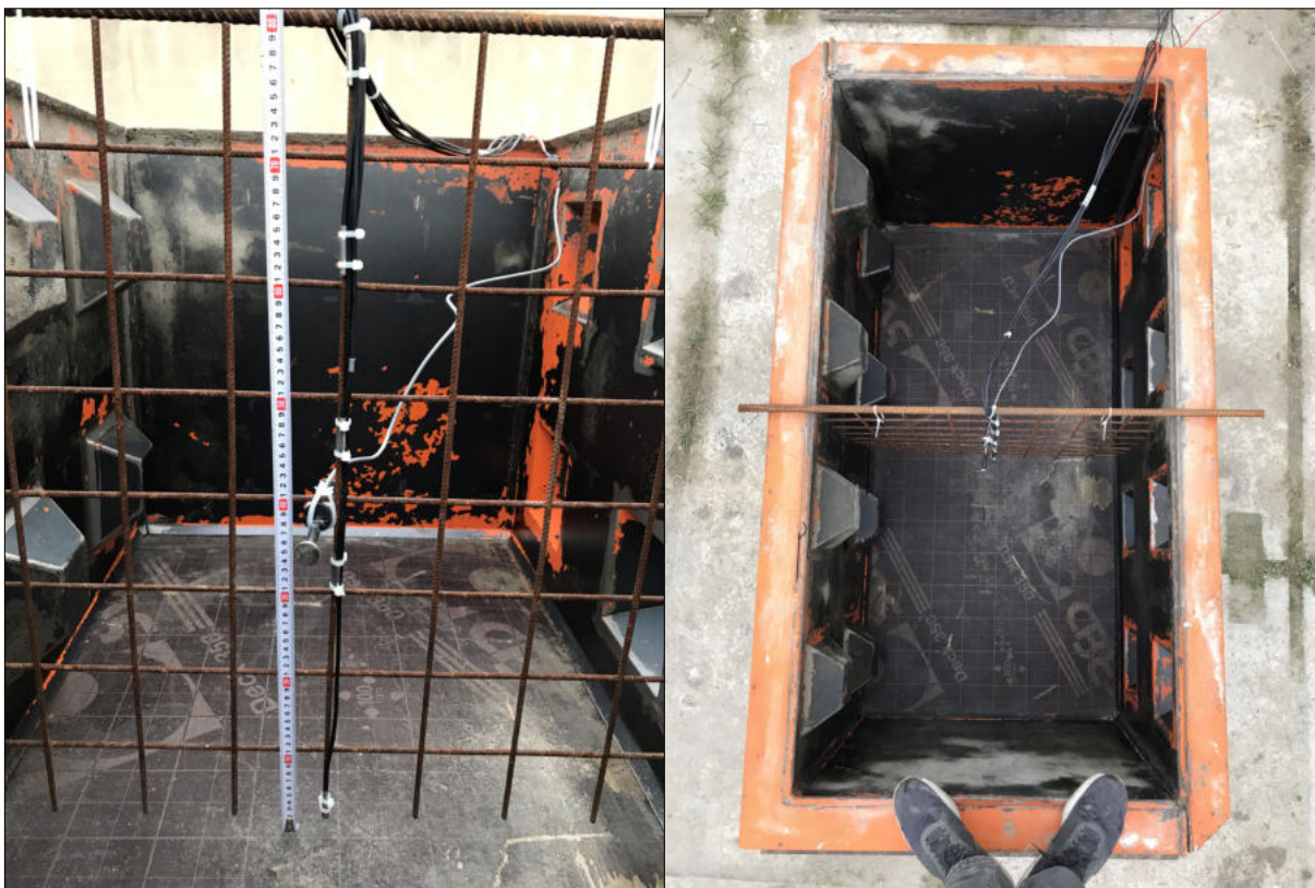
Obrázek C.3: Umístění teplotních čidel a strunového tenzometru po výšce průřezu; Pohled shora do formy.
