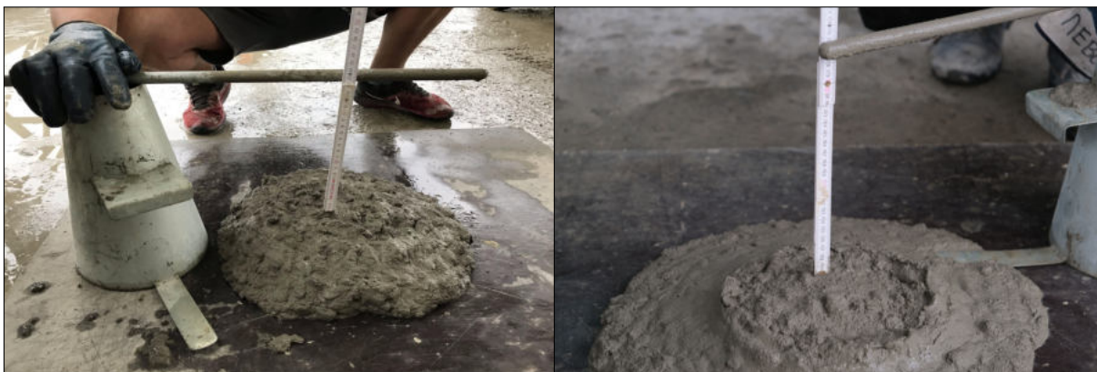
Obrázek C.5: Sednutí kužele varianty REF; Sednutí kužele varianty XYP.
