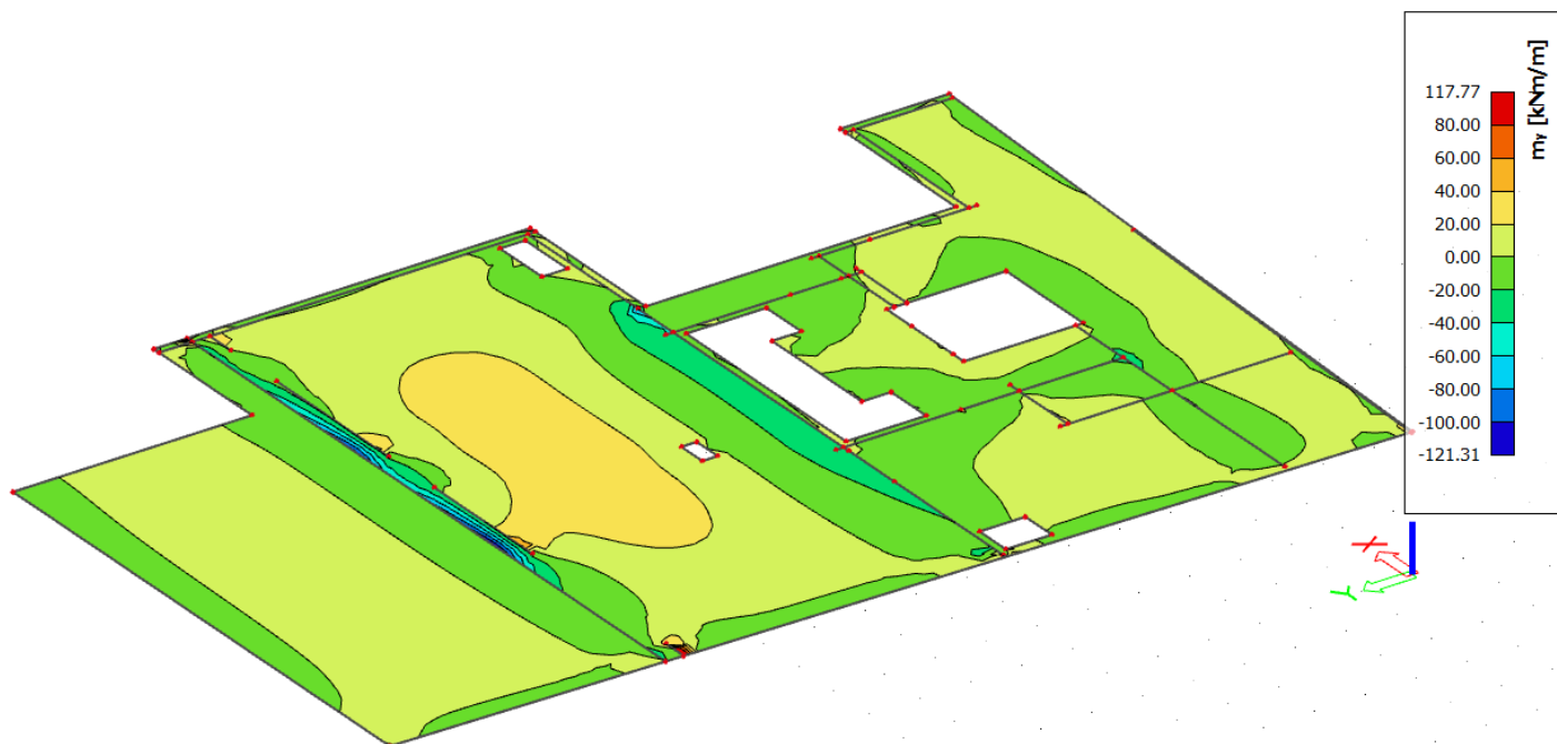
3D model – Ohybový moment m_y na stropní desce 1.PP
