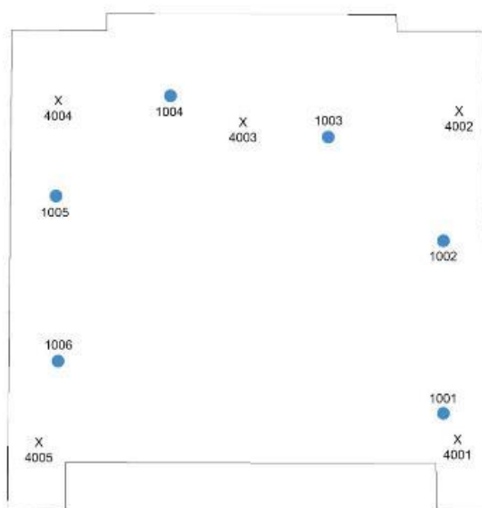
Obrázek 14 - schéma rozložení kulových terčů a stanic v přednáškové učebně
