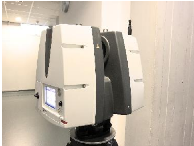
Obrázek 10 - skenovací stanice Leica ScanStation P40
