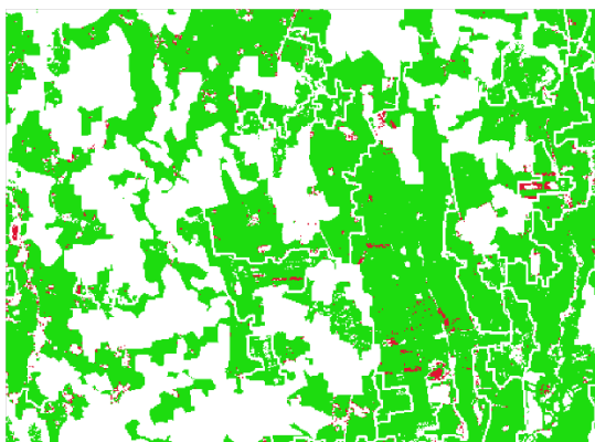
Shoda klasifikace s trénovacími plochami, 1. úroveň CLC (zelená = shoda, červená = rozdíl oproti trénovacím datům)
