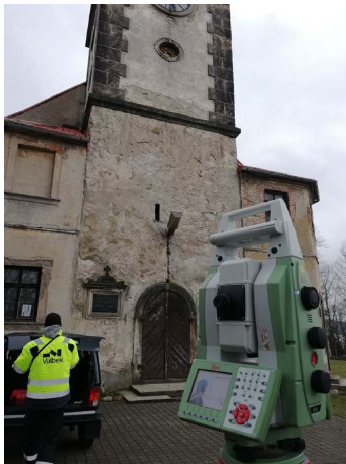
Obr. 3.7: Měření bodů na průčelí kostela
