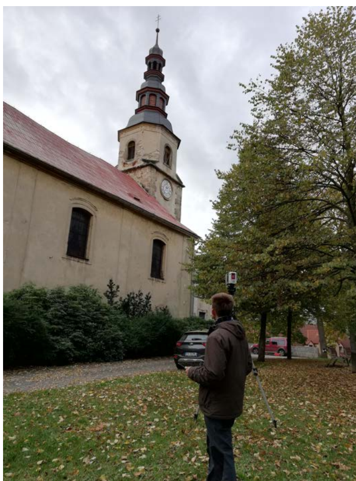
Obr. 3.9: Skenování exteriéru kostela
