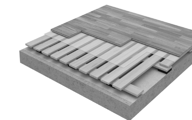
Podlaha sportovních ploch Systémová dřevěná podlaha BOEN Singleflex Olympia Dvojitý odpružený dřevěný rošt na pružných podložkách Nášlapná vrstva z tvrdého dřeva
