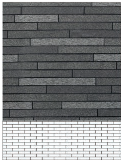
P1 - dlažba betonová tmavá
