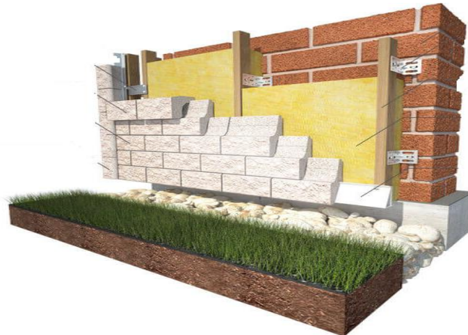
Obrázek 39 Schéma zateplení cihlou Llifebrick
