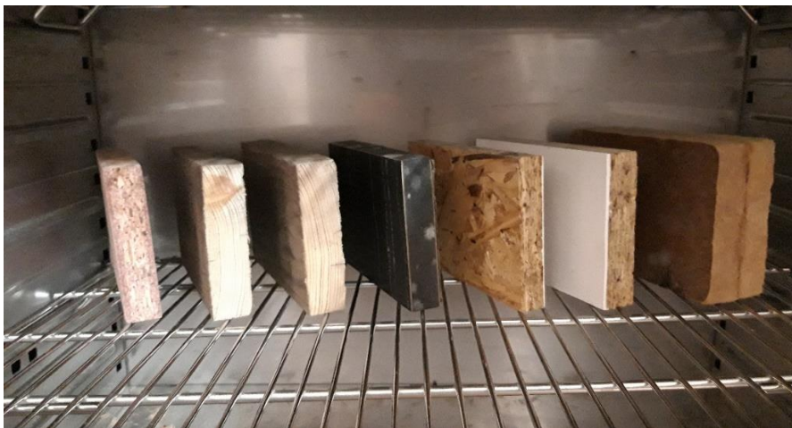
Obrázek 10: Umístění vzorků v klimatizační komoře
