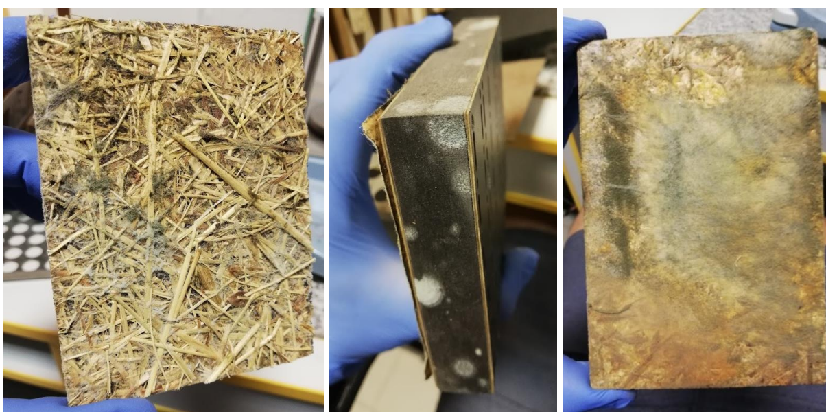
Obrázek 15: Organoid, zvukově izolační MDF, Slámová deska
