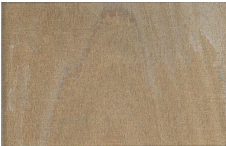
Obrázek 24: Mapy protipožárního nátěru (Pyroplex) na bukové překližce
