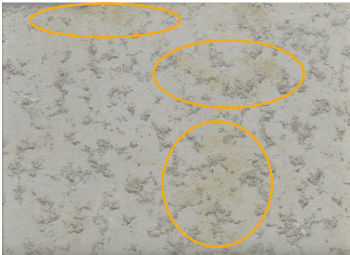
Obrázek 26: Zabarvení betonové stěrky při RH 85%
