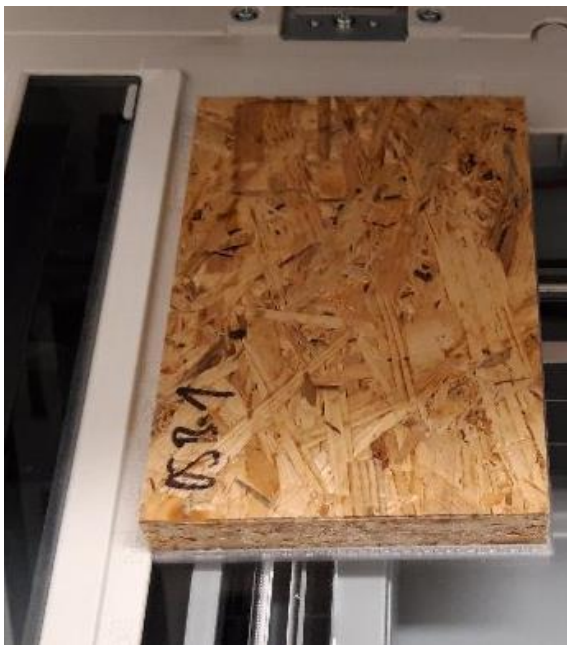
Obrázek 33: Skenování vzorků na distančním rámečku
