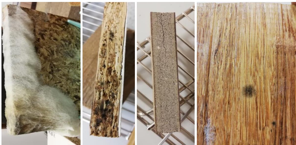
Obrázek 13: Slámová deska, OSB/3 s protipožární úpravou, pěnové sklo, bambusová podlaha
