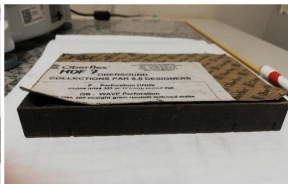
Obrázek 12: Modřín opalovaný + epoxidový nátěr, zvukově izolační MDF
