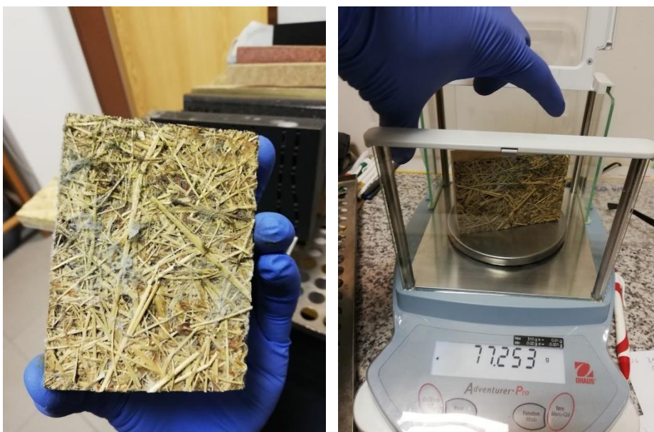
Obrázek 11: Manipulace se vzorkem Organoidu v gumových rukavicích, aby se zamezilo jeho kontaminaci
