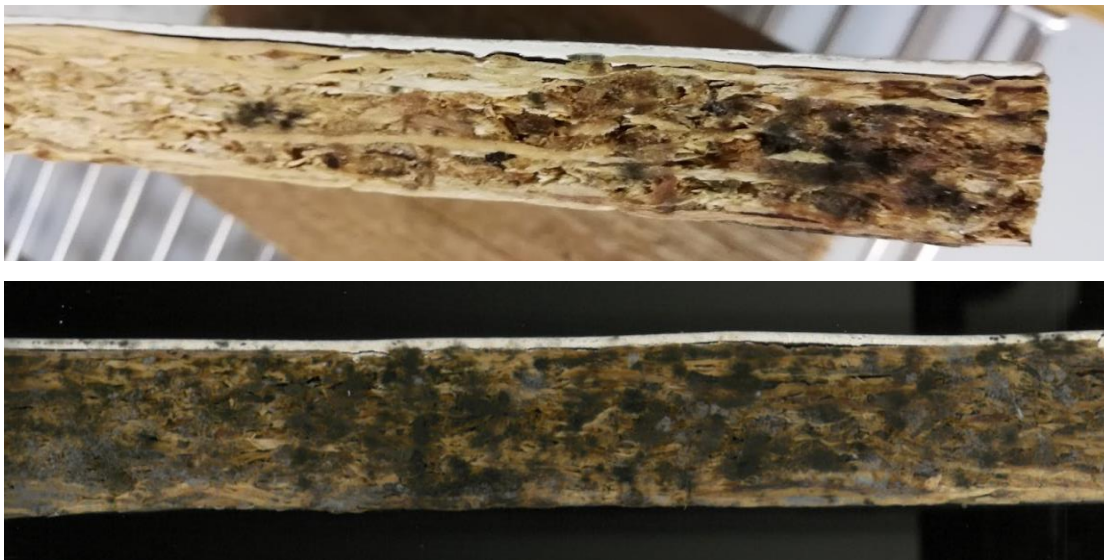
Obrázek 28: Horní hrana OSB/3 s protipožární úpravou RH 90% (3. cyklus), RH 90% (6. cyklus)
