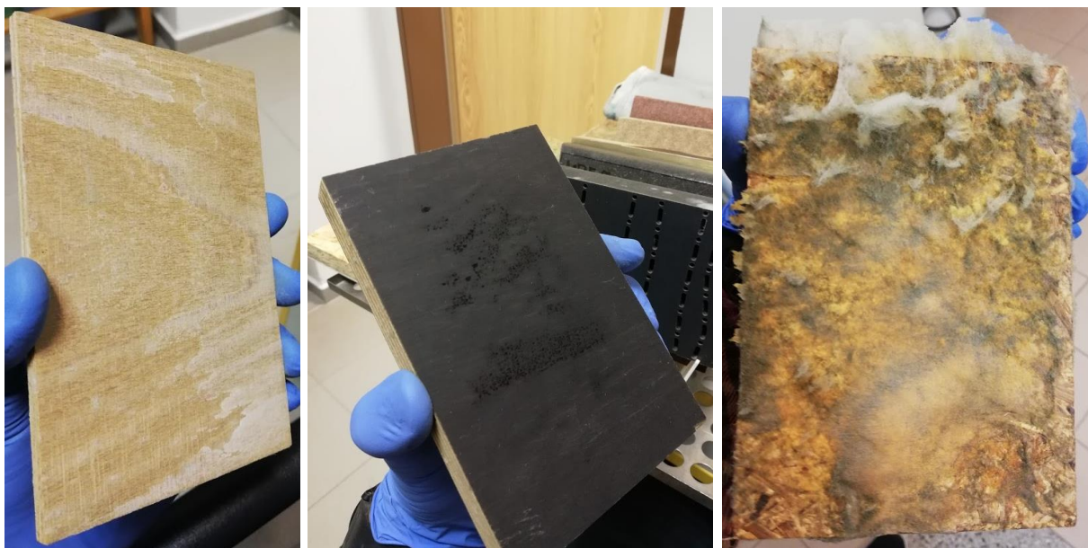
Obrázek 14: Buková překližka + protipožární nátěr, voděodolná překližka stavební, slámová deska
