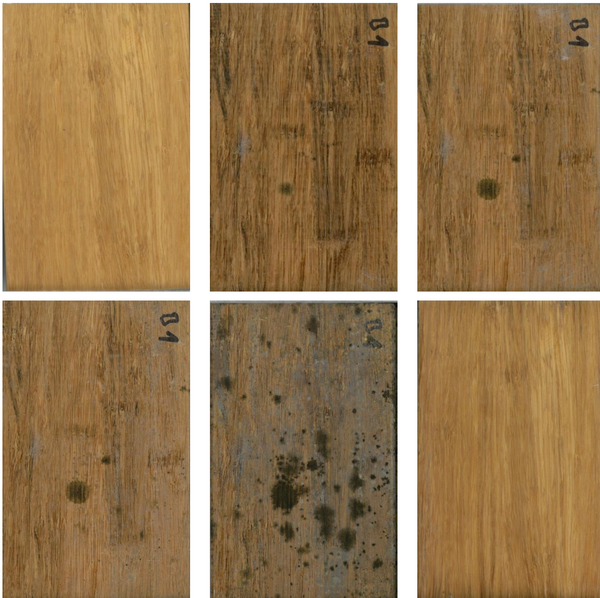
Obrázek 37: B1 – Bambusová podlaha: Rh: 0% (čelní str.), 90%, 85% (desorpce), 80% (desorpce), 90%, 90% (čelní str.)
