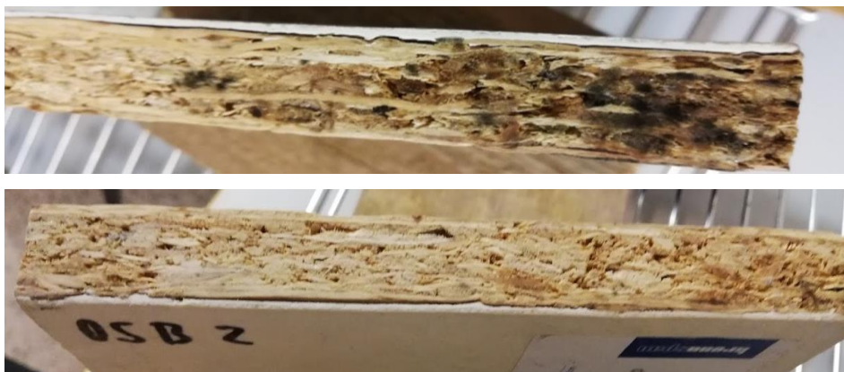
Obrázek 25: Oddělení protipožární vrstvy na vzorku OSB/3 s protipožární úpravou
