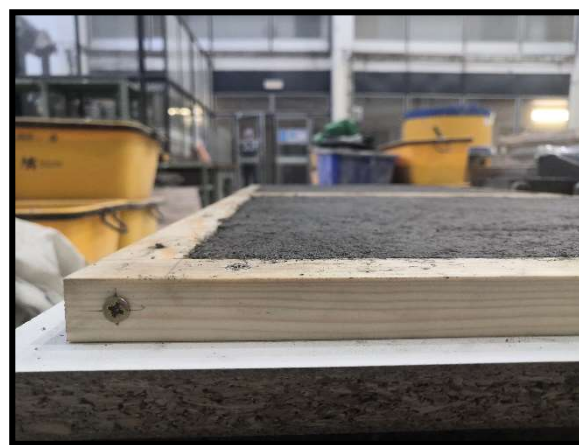
obrázek č. 39: Detail rohu a rovinatosti desky
