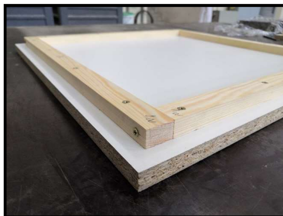
obrázek č. 33: Detail rohu bednění
