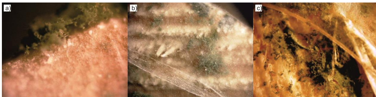
Obr. 7 Vzorok dřeva s nanotextiliemi: a) mikroskopický snímek růstu plísně na dřevěném vzorku opatřeném nanotextilií PVA po 32 dnech; b) mikroskopický snímek mycelia hub protkaných v celé struktuře nanovláknenné textilie PVA; c) poškozená nanotextilie PVA s biocidem v infikovaném dřevě
