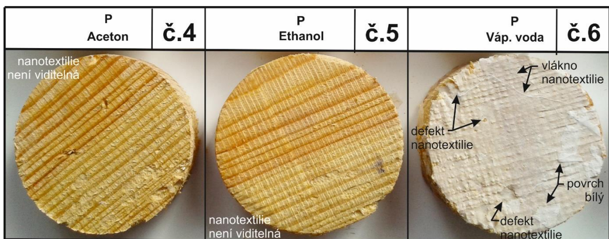
Obr. 27c Detaily vzorků dřeva po aplikaci nanotextilie Paraloid B72
