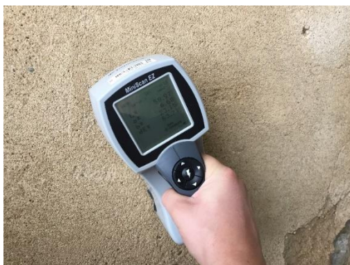
Obr. 84 Měření změn barevné vrstvy omítané kamenné (opukové) zdi in situ v Praze pomocí spektrofotometru HunterLab MiniScan EZ 4000S
