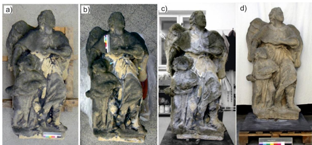
Obr. 17 Barokní socha anděla s dítětem z domu čp. 48 v Kutné Hoře, průběh prací: a) po očištění tmelů a odtržených sádrovcových krust před konsolidací; b) stav po 1. napouštěcím cyklu; c) stav sochy po dokončení strukturální konsolidace prostředky CaLoSiL; d) stav po restaurování
