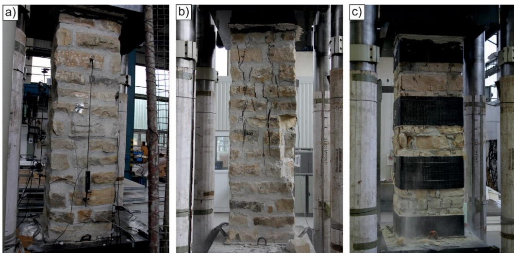
Obr. 17: Experimentálně zkoušený pilíř z nepravidelných zdicích prvků – nezesílený neporušený (a), nezesílený porušený (b), zesílený porušený (c)
