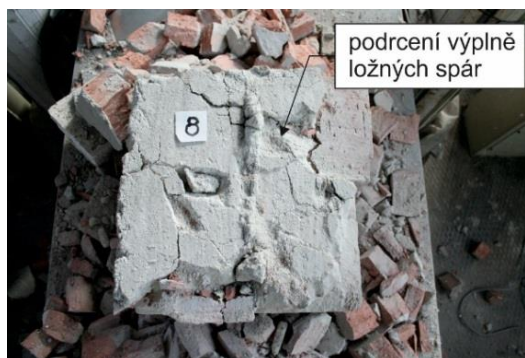
Obr. 70: Rozpad výplně ložné maltové spáry při experimentálním zatěžování cihelného pilíře dostředným tlakem
