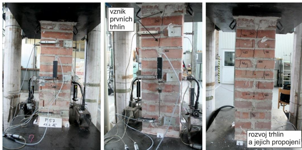
Obr. 12: Postupné porušování pilíře při experimentálním zatěžování
