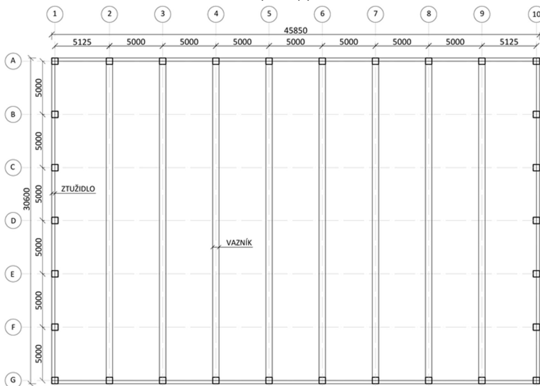
Obr. 5.1 Konstrukční systém sportovní haly
