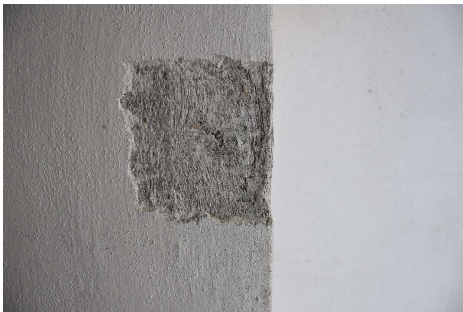
Obr. 8 – Očištěné zkušební místo o rozměrech 180x240mm pro zkoušku Schmid. tvrdoměrem
