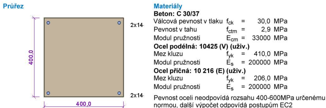
Obr. 19 – Průřez sloupu a vstupní data k výpočtu [20]
