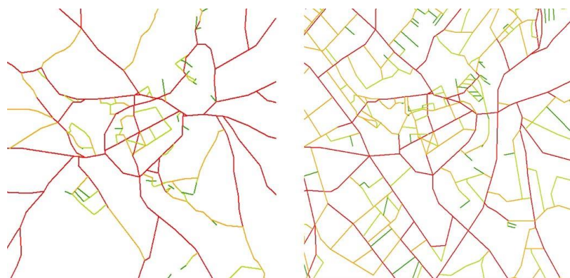
fig D—32 Space syntax – ukázka analýzy choice (potenciál pohybu) v uliční síti na příkladu Pelhřimova (srovnání pol. 19. stol. a současnosti: tmavě červená značí nejvyšší potenciál, zelená nejnižší)
