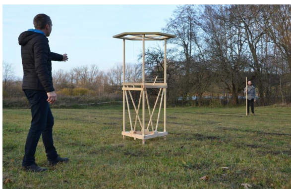
fig D—42 Použití prototypu gromy D16 při experimentálním vytyčování půdorysné osnovy města v terénu, podzim 2018
