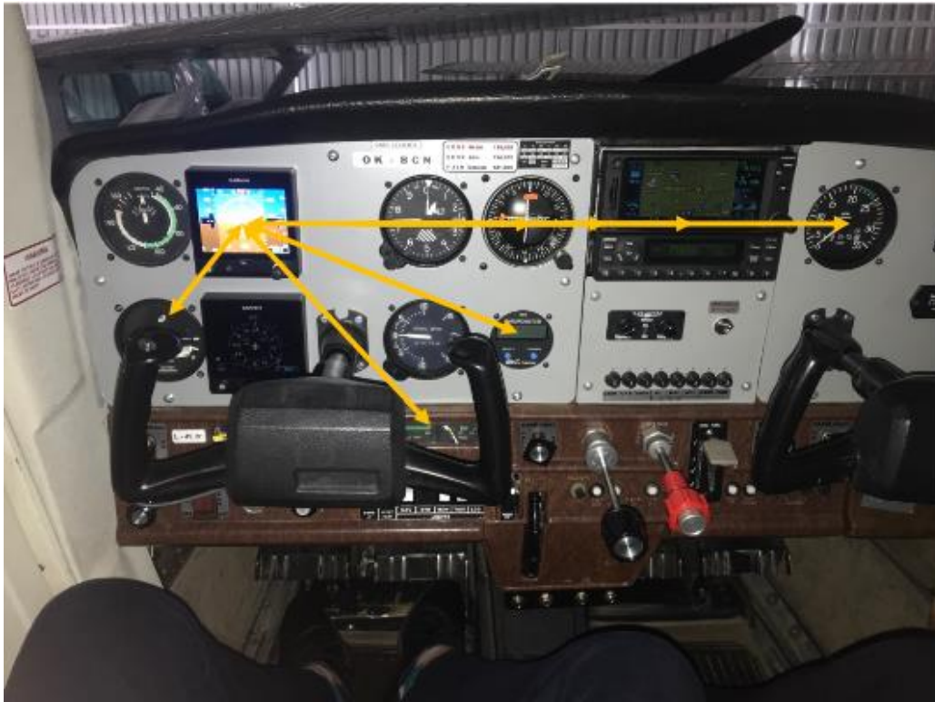
Obrázek 3: Příklad vhodného vybavení letounu C152 pro přístrojové lety. Součástí avioniky je dvakrát Garmin G5 a Garmin GTN650 [8]
