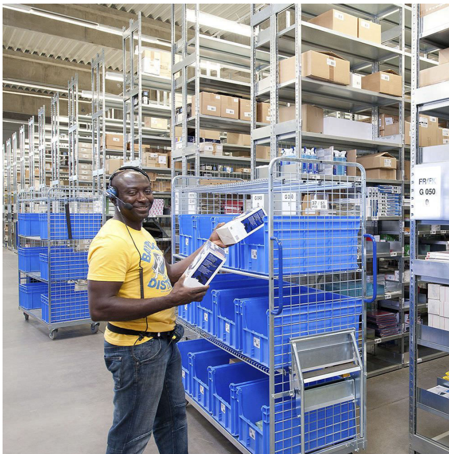
Obr. 4.1: Špeciálny vozík, používaný pri vyskladňovaní viacerých objednávok naraz [17]
