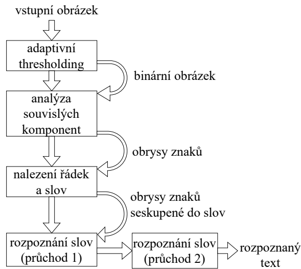
Obrázek 1.1: Tesseract architektura. Zdroj: [5, překresleno, přeloženo]
