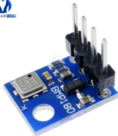
Obrázek 3.4: Čidlo BMP180 pro měření tlaku [13]
