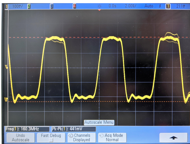
Obrázek C.5: Maximální deklarovaná frekvence SI5351, tentokrát se zátěží. Vidíme přesnější tvar obdélníka.
