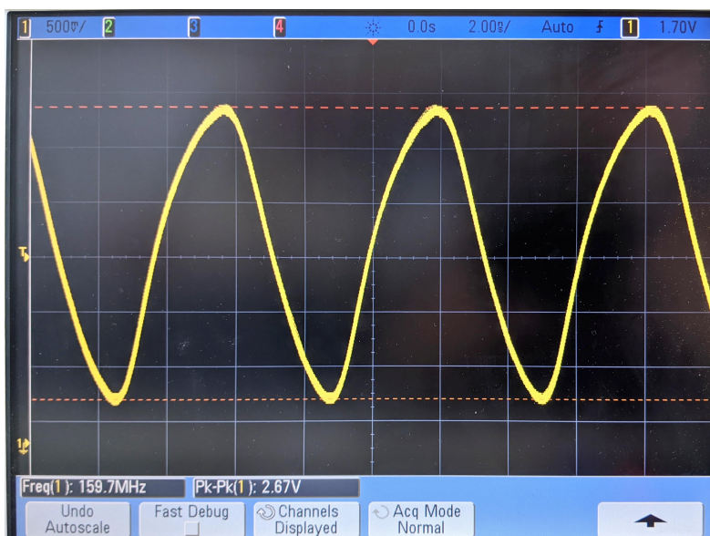
Obrázek C.4: Maximální deklarovaná frekvence generátoru SI5351, tedy 160 MHz. Měřeno bez zátěže, proto má výstup téměř trojúhelníkový tvar. Zajímavé ale je, úplně zmizela zkreslení, která byla patrná v nižších frekvencích.
