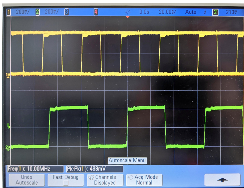
Obrázek C.7: Měření dvou výstupů generátoru SI5351, oba se zátěží. Na prvním kanále je frekvence 10 MHz, na druhém 5 MHz
