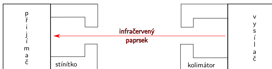
Obrázek 4: Podstata technického řešení; infračervená závora s kolimátorem a stínítkem.
