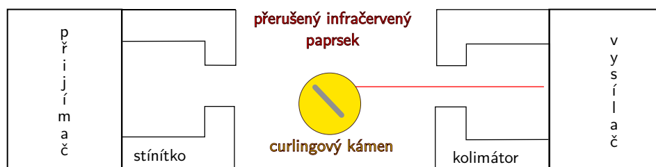
Obrázek 5: Přerušování infračerveného paprsku curlingovým kamenem.
