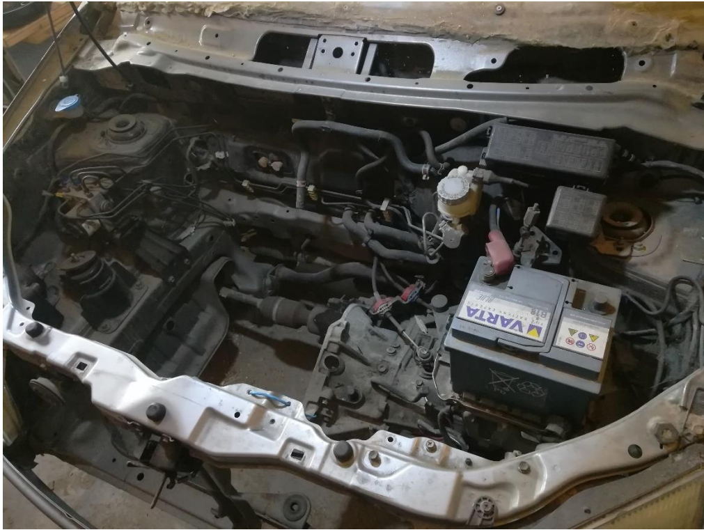
Příloha 1 – Fotografie motorového prostoru po demontáži motoru (zdroj: Ing. Miroslav Vitek, CSc.)
