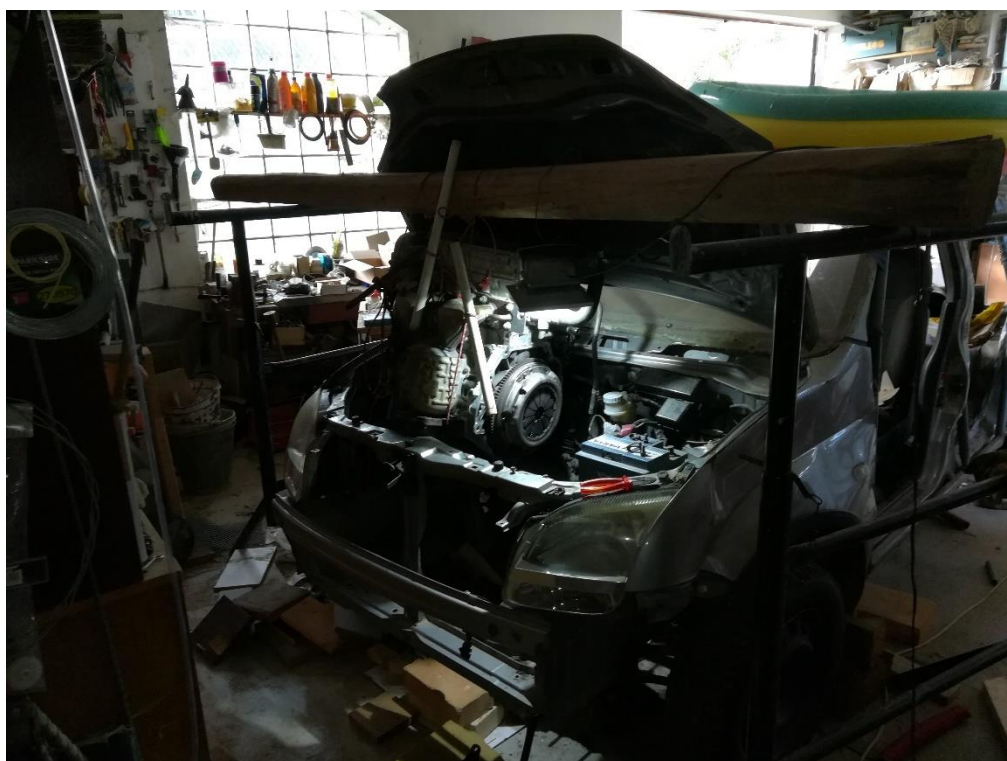
Příloha 4 – Demontáž spalovacího motoru (zdroj: Ing. Miroslav Vitek, CSc.)
