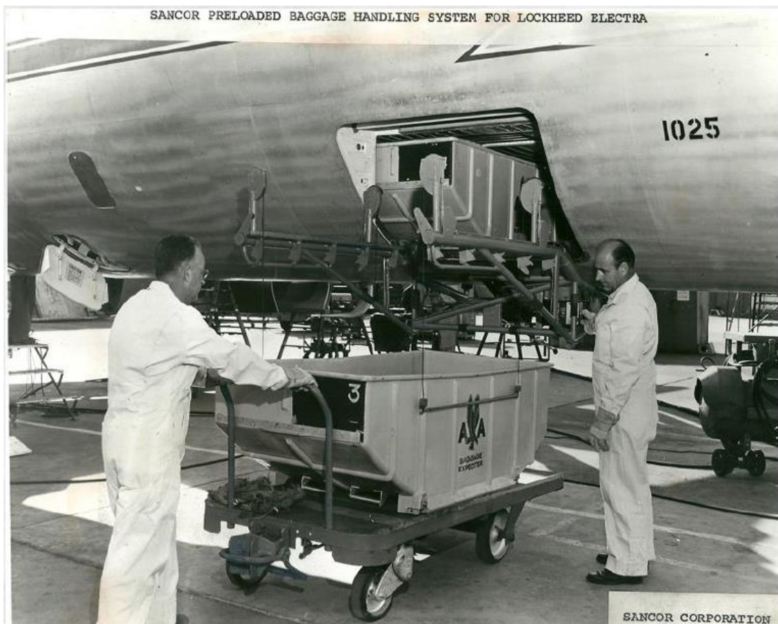
Obrázek 1 - Nakládání prvních typů ULD do letadla Lockheed L-188
