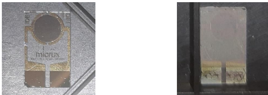
Obrázek 3.6 Fotografie interdigitálního senzoru bez a s aktivní diamantovou vrstvou
