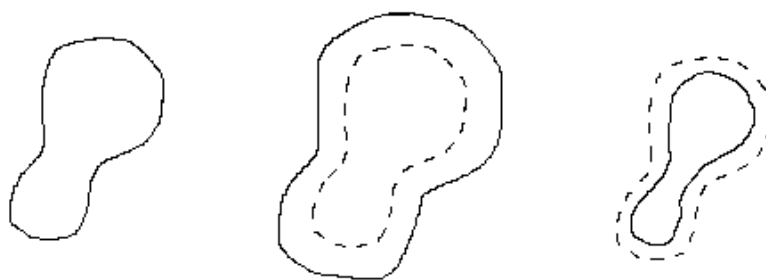
Obrázek 8.7: Porovnání aplikace dilatace (uprostřed) a eroze (vpravo). Vlevo je původní obraz [14].
