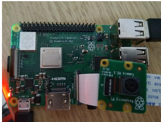
Obrázek 5.3: Ukázka pracovního zapojení RPI. Přes CSI rozhraní je propojená RPI kamera. Kódový zámek je připojen skrze USB rozhraní. V pracovní verzi je pro funkci kódového zámku použita klávesnice.
