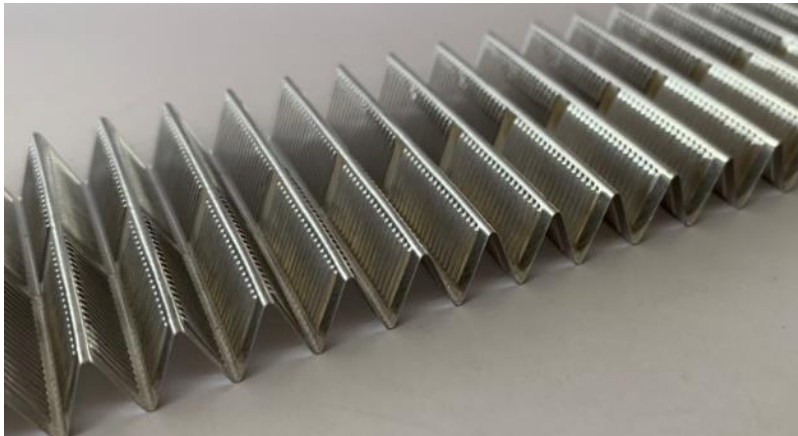
Obr. 17.: Detail vlnovce s prostřihem. [Foto autor]
