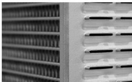
Obr. 3.: Síť chladiče složeného z tenkostěnných trubek. [Foto autor]
