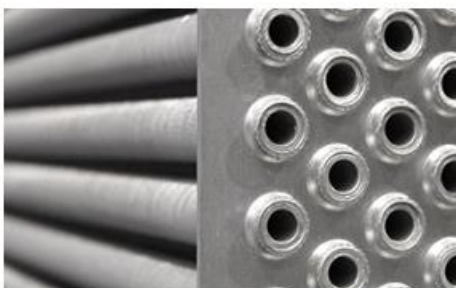
Obr. 4.: Síť chladiče složeného z žebrovaných trubek. [Foto autor]
