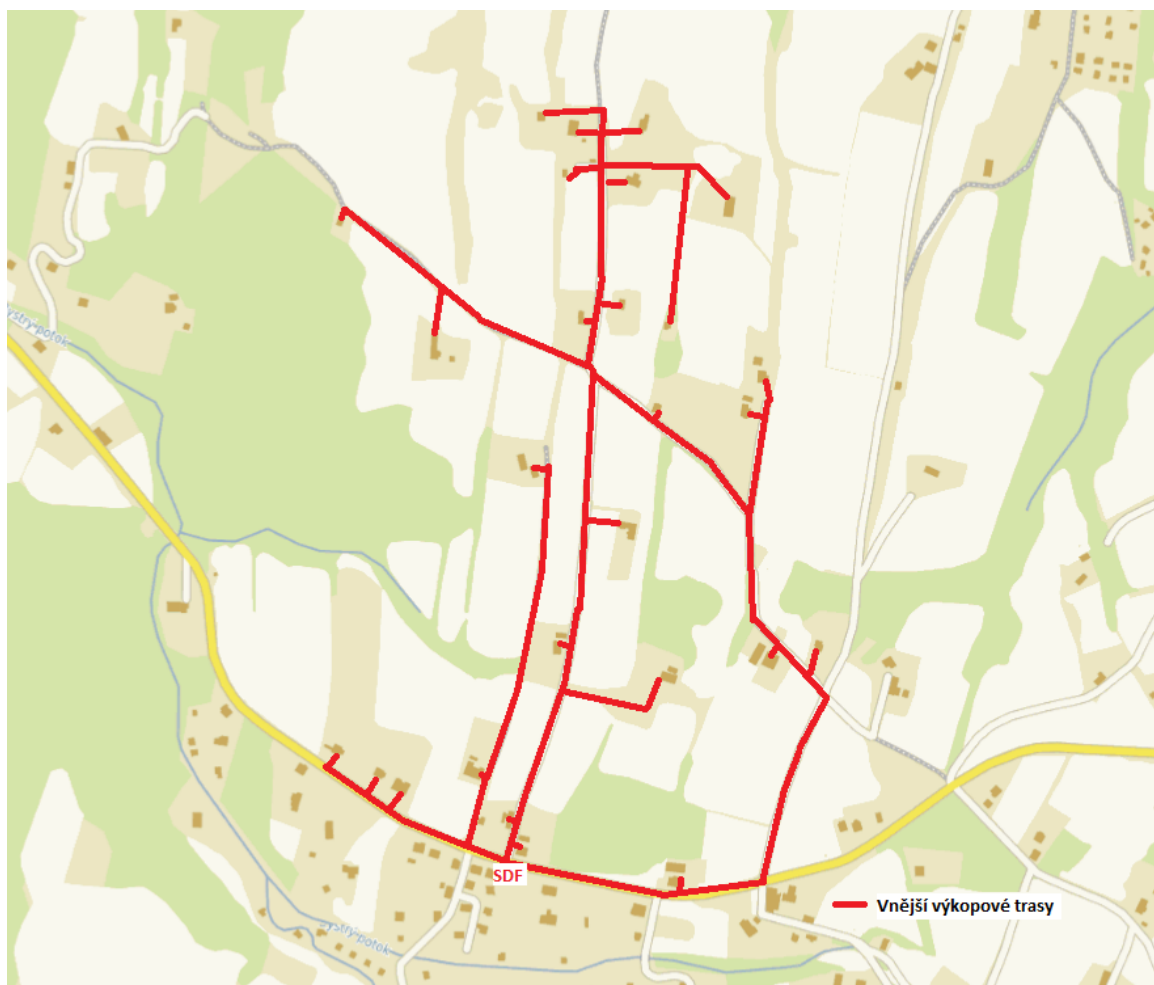
Obrázek E.10: Schéma výkopových prací pro trasy výkopů - samoty
