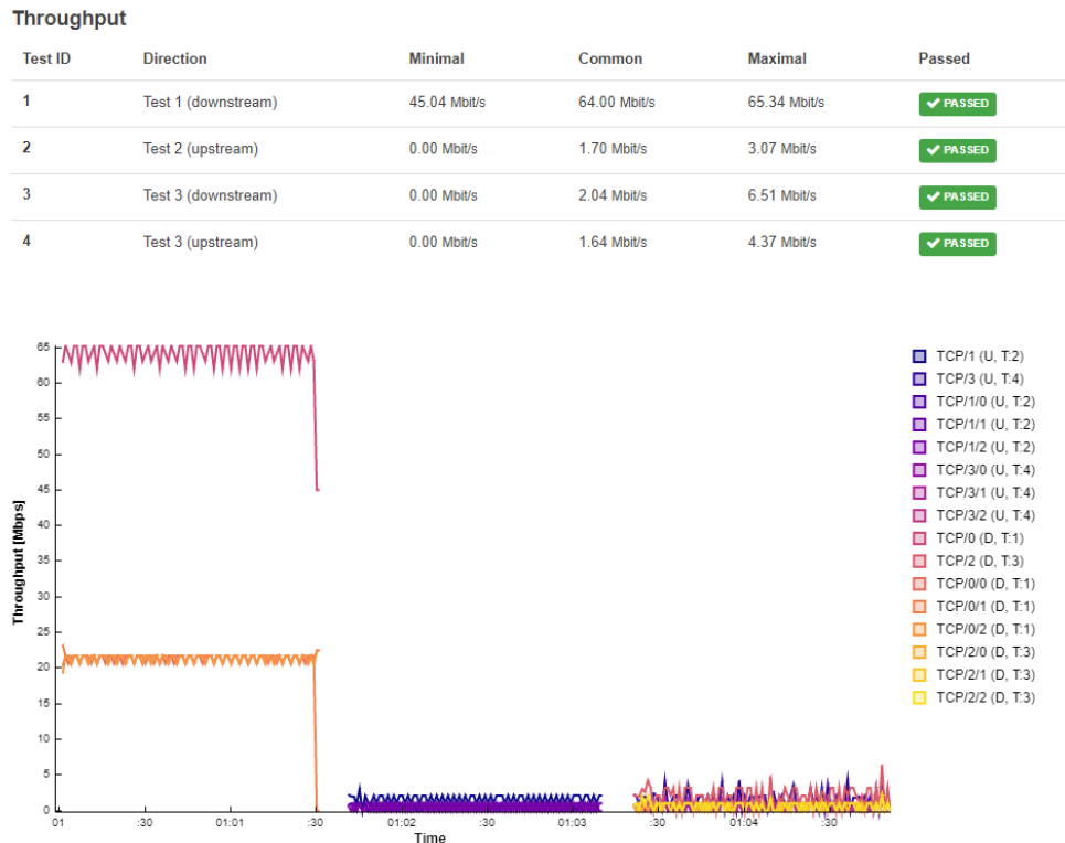
Obrázek 4.15: Výpis z F-Testeru po testu se schématem NGA basic na technologii GPON
