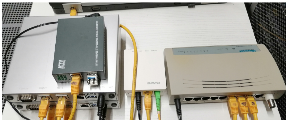
Obrázek 4.13: Vyfocená zapojená sestava, která byla použita pro měření parametrů na technologii GPON
