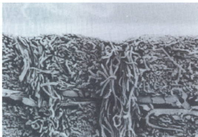
Obr. 7 Řez filtrační textilie s vpichovanou vláknitou vrstvou Fig. 7 Cross section of filtering fabric with needle-felted layer
