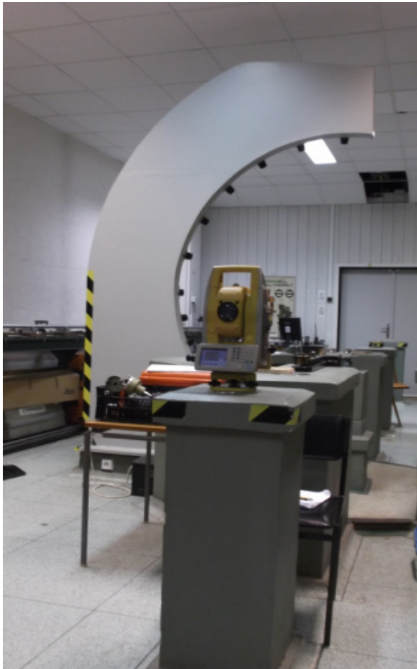
Obr. 5.2.2 Totální stanice na stabilizovaném bodě č. 8
