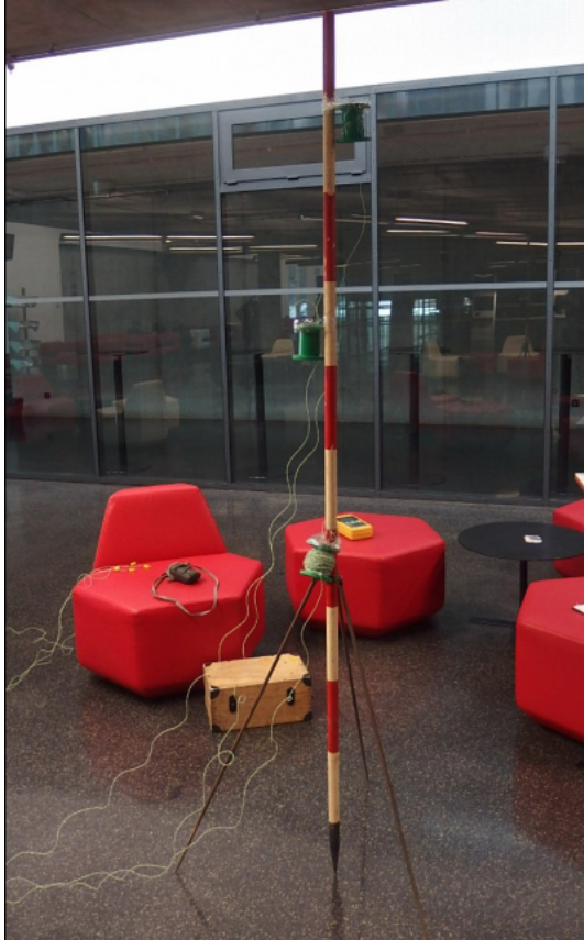
Obr. 4.4.2 Upevnění teplotních čidel na výtyčce
