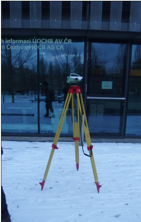
Obr. 4.3.1 Nivelační přístroj DNA 03, měření 8. února 2015
