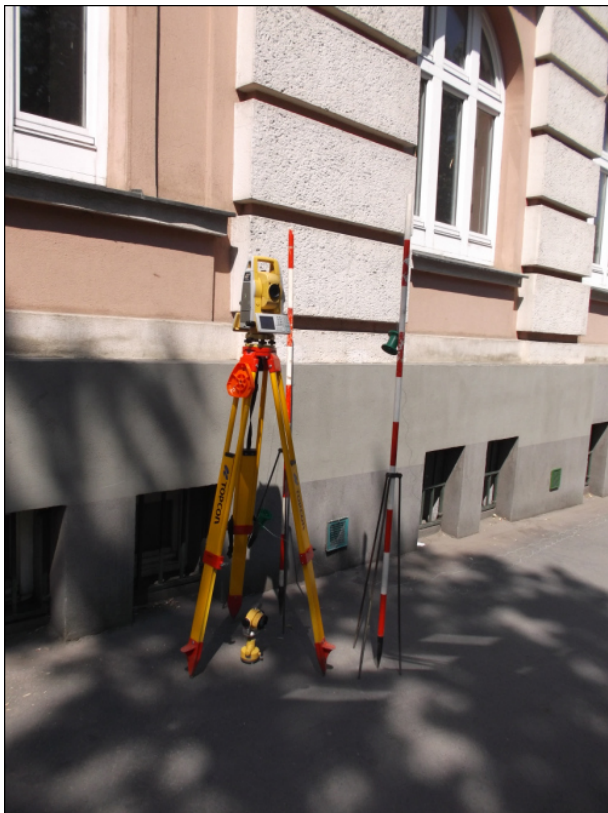
Obr. 5.3.2 Rozestavení přístroje a teplotních čidel
