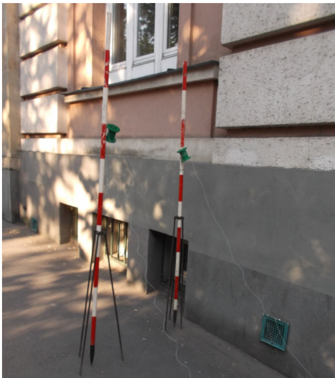
Obr. č. 5.3.3 Teplotní čidla umístěná na výtyčkách
