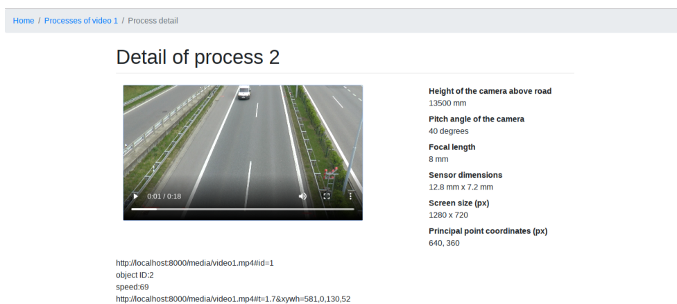
Obrázek 4.5: Ukázka stránky s detailem procesu se zobrazenou rychlostí objektu, identifikátorem a příslušnou anotací
