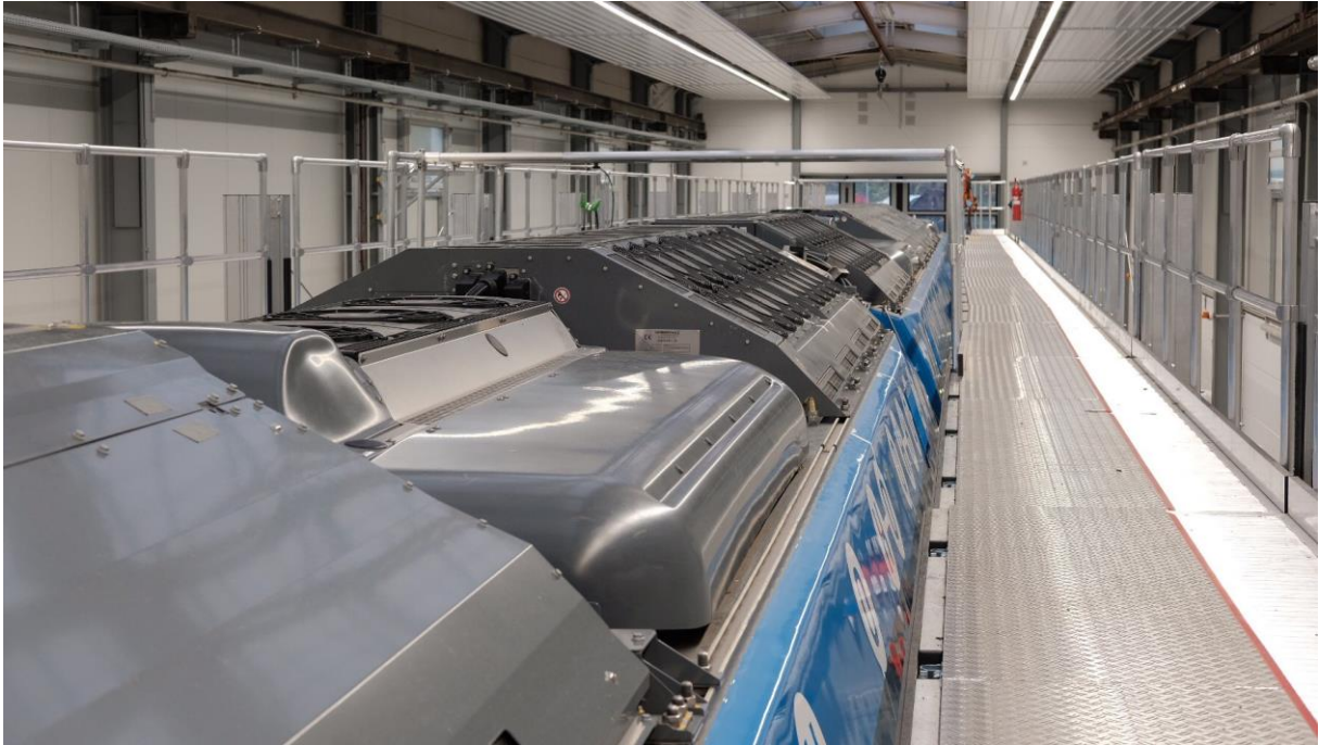
Obrázek 10 Palivové články a vodíkové nádrže na střeše HMU Alstom iLint [22]
