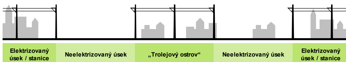
Obrázek 26 Provozování BEMU na neelektrizovaném úseku s „trolejovými ostrovy“ [autor]
