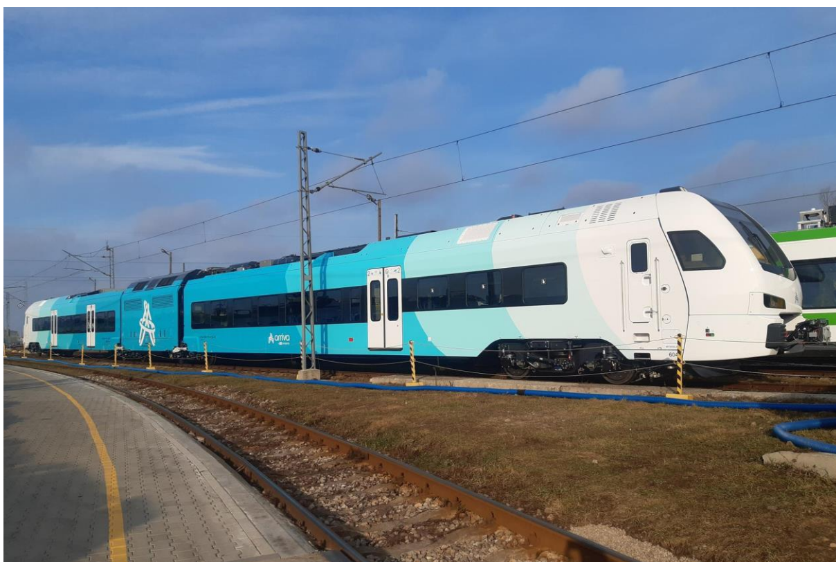
Obrázek 33 Stadler Wink DMU ve verzi na HVO s možnou přestavbou na BEMU [89]
