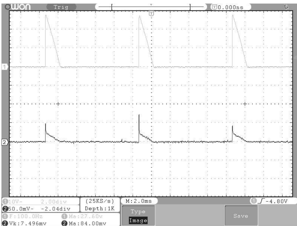
Obr. 32 Průběh napětí a proudu na výstupu dobijče v oblasti dovolených proudů. Nahoře: průběh napětí na zátěži, 10 V/d; dole: průběh proudu zátěži, 3,7 A/d.
