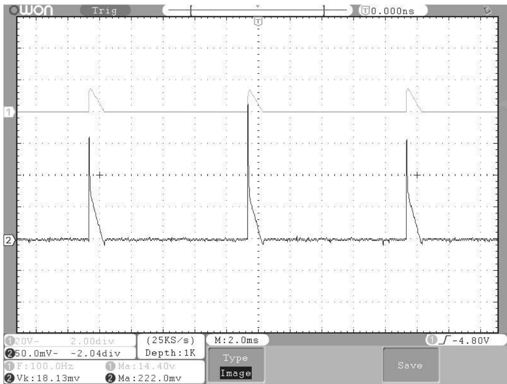
Obr. 33 Průběhy napětí a proudu dobíječe při zásahu proudového omezení. Nahoře: průběh napětí na zátěži, 10 V/d; dole: průběh proudu zátěží, 3,7 A/d.
