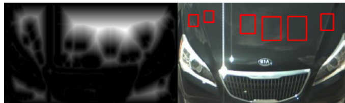
Obrázek 3: Metoda transformace vzdálenosti: 1) binární maska, 2) oblasti zájmu [39]
