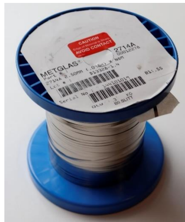
Obrázek 6 - Feromagnetická amorfni páska METAGLAS 2714A
