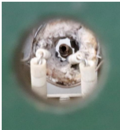
Obrázek 65 - Detail topení a termočlánu v izolovaném válci
