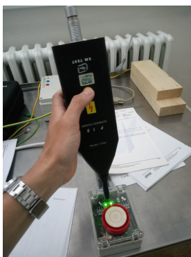
Obrázek 5.5: Zkouška elektrostatickým výbojem
