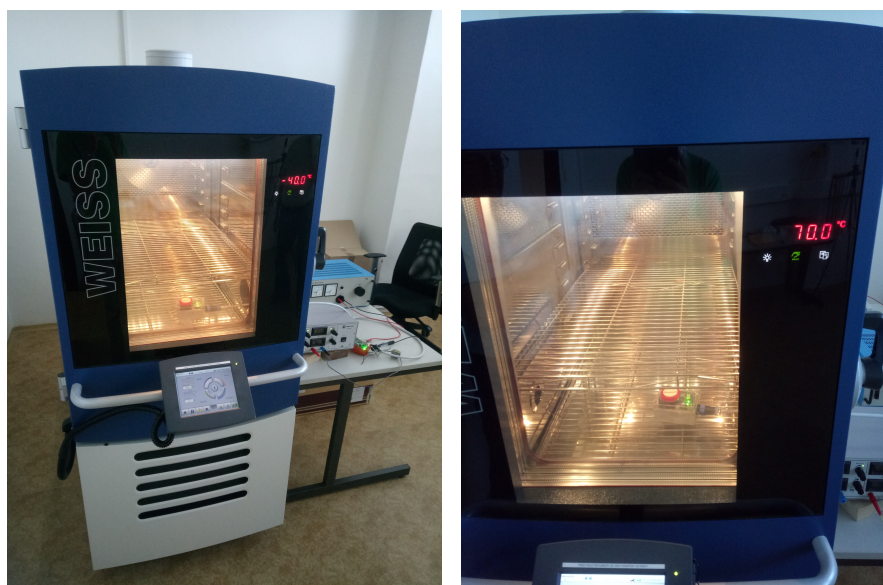
(a) : Studený start při -40^{\circ}\text{C}
