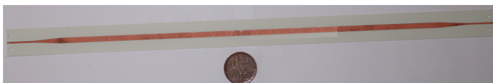
Obrázek 4.1: Vyrobená CRLH struktura složená ze čtvercových buněk
