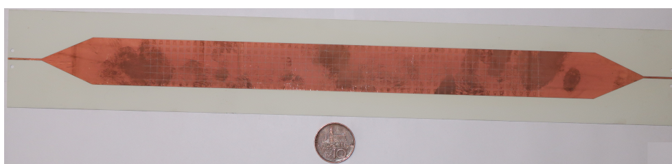
Obrázek 4.2: Vyrobená CRLH struktura složená ze čtvercových super-buněk
