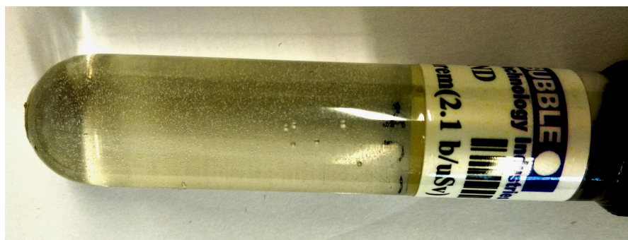
Obrázek 5.11: Detail bublinkového detektoru s několika viditelnými bublinkami.
