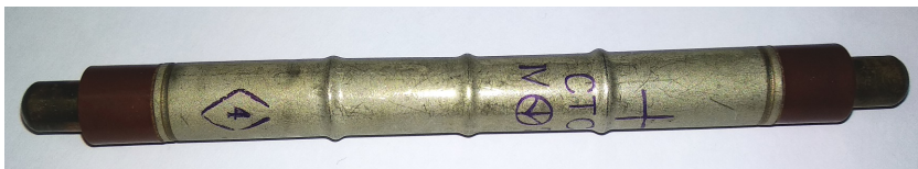
Obrázek 5.4: Typ Geiger-Müllerovy trubice použité v aktivačním detektoru.
