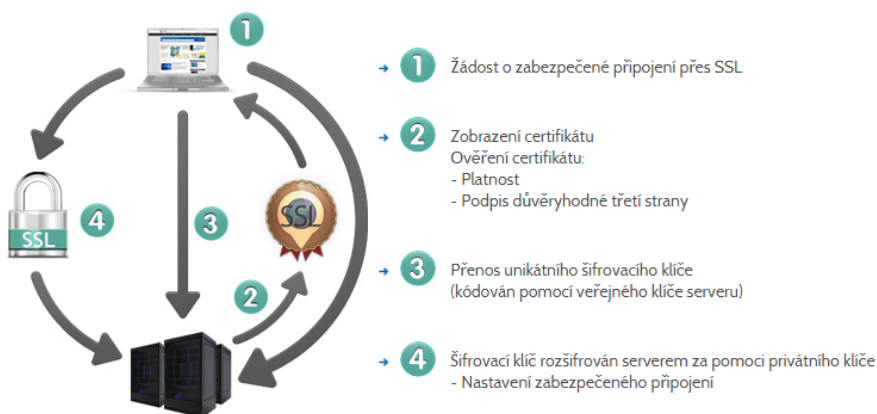
Obrázek 2.5. Princip fungování SSL/TLS [16]
