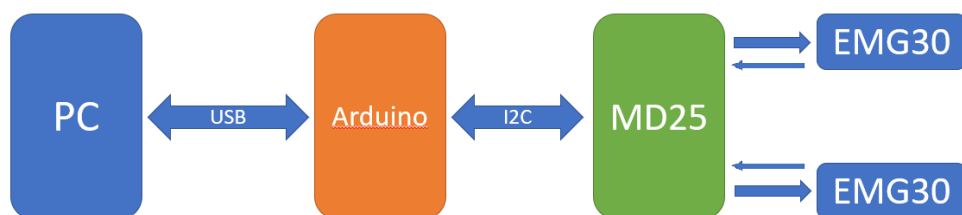
Obrázek 4.1: Robotická jednotka – schéma komunikace
