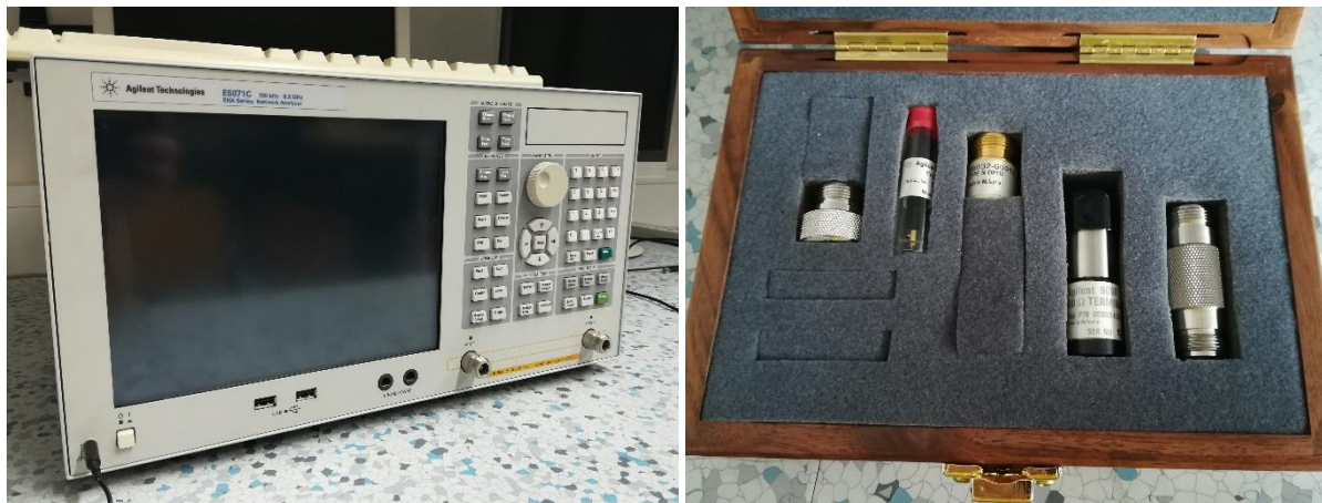
Obrázek 65 - Vektorový analyzátor E5071C (vlevo), kalibrační sada Agilent 85032E (vpravo)
