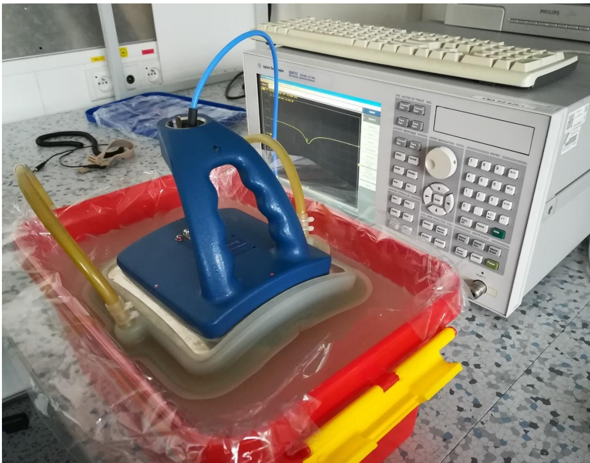
Obrázek 68 - Měření průběhů parametru S_{11} na agarovém fantomu
