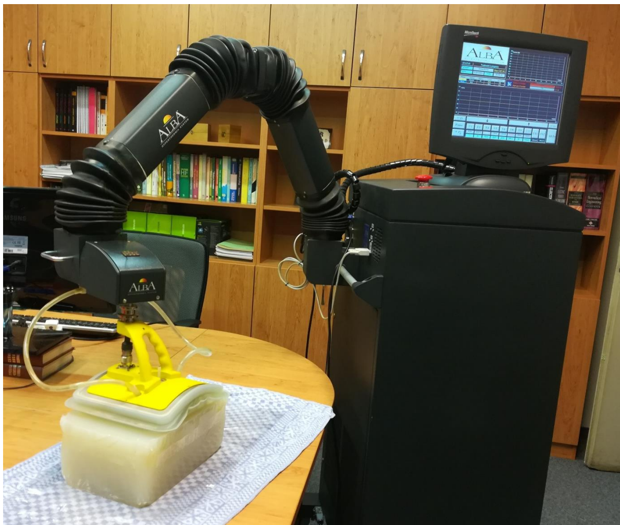
Obrázek 72 - Měření rozložení parametru SAR na agarovém fantomu
