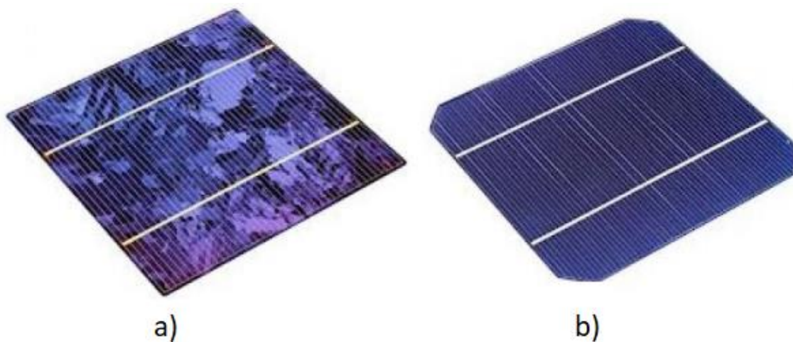
Obr. 2-4 Křemíkový článek a) polykrystalický b) monokrystalický 8
